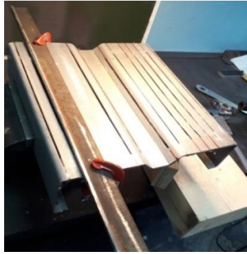
Рис. 3. Вырезка стальных полос для проведения испытания на растяжение
