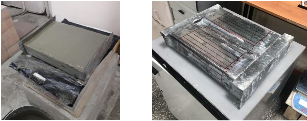
Рис. 5. Образец сигма-профиля для измерения твердости
