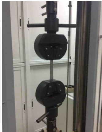
Рис. 4. Испытание образца на разрывной машине И1147М-50-01-1
